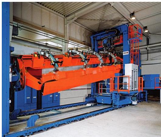
*Рисунок 2 – клепальный станок Brotje Automation СРАС*
