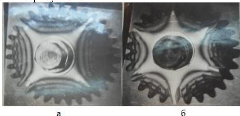
Рисунок 1 - Формы колебаний, полученные экспериментально:
