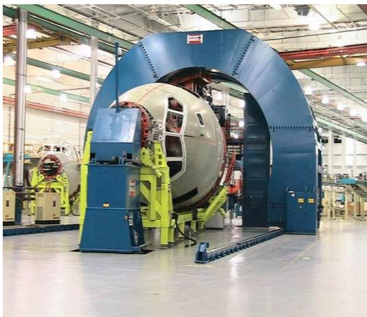
*Рисунок 1 – Интегрированная система сборки агрегатов Brotje Automation ISAC*
