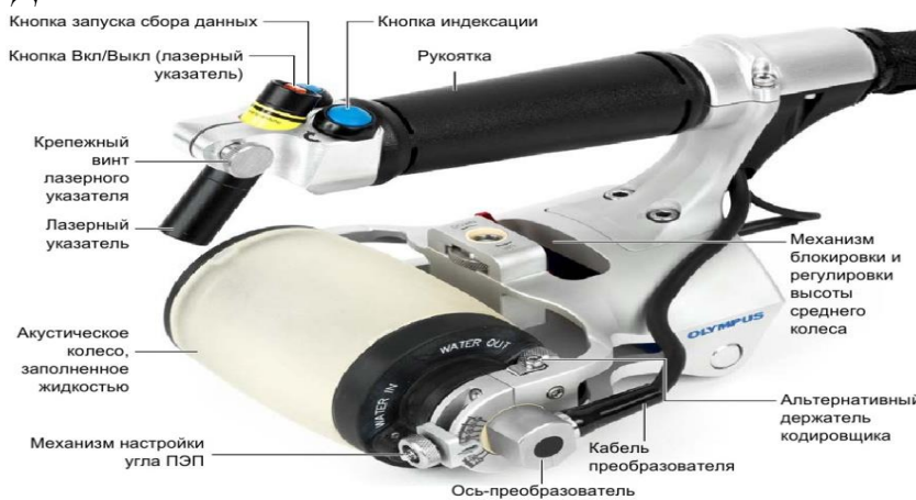
Рис. 2. Ультразвуковой преобразователь RollerFORM, в сочетании с ФР-дефектоскопом OmniScan
