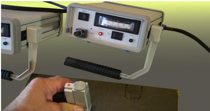
Рис. 2. Акустический импедансный дефектоскоп ИД-91М
