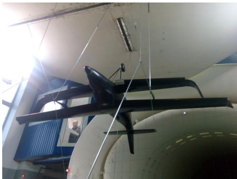
Рис. 1. Модель самолёта на аэродинамических весах в рабочей части аэродинамической трубы
