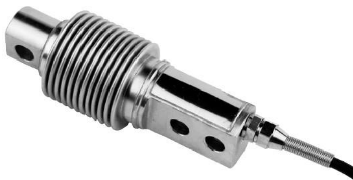
Рис. 2. Тензодатчик для измерения шарнирного момента
