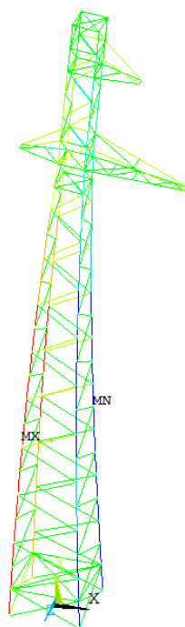
Рис. 3. Полученное поле распределения эквивалентных напряжений (слева) и разрушенная конструкция (справа)
