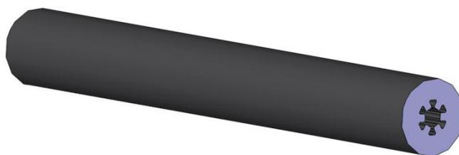
Рис.3. Заряд твердого топлива со звездообразным 6-лучевым центральным каналом.
