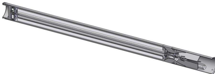
Рис.2. Штатный РДТТ для НАР С-8 со звездообразным 3-х лучевым зарядом твердого топлива.
