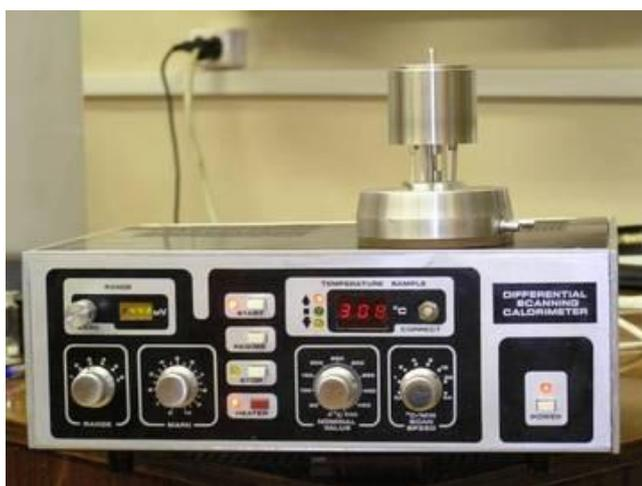
Рисунок 1 – Дифференциальный сканирующий калориметр ДСК-500
