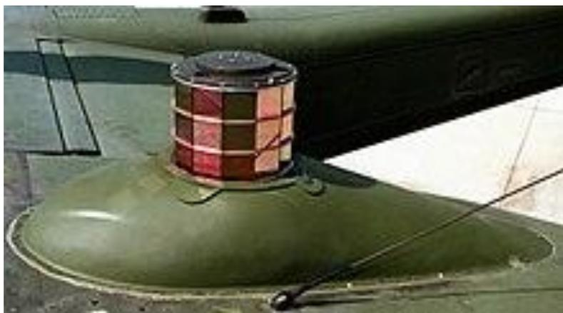
Пример генератора пульсирующих инфракрасных помех ALQ-144 «Хот брик» на фюзеляже самолёта OV-10D «Бронко»
