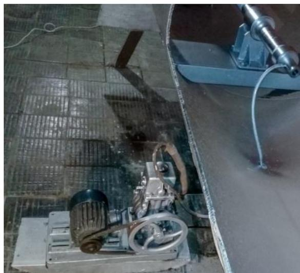
Рисунок 3 – Система вакуумирования ствола
