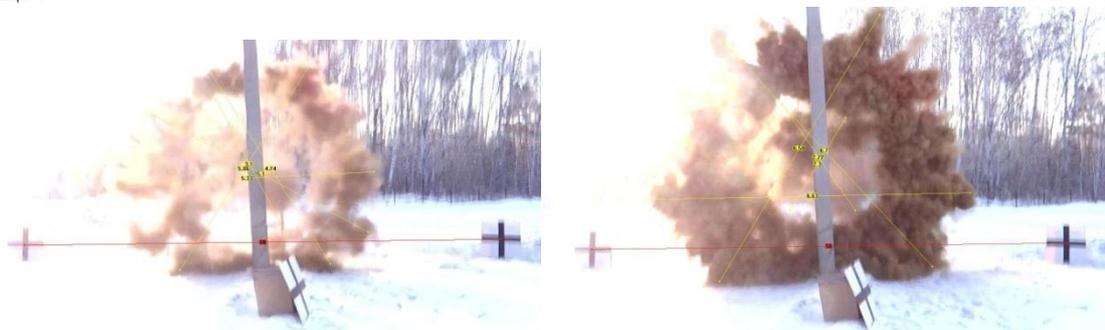
Рис.2.1. Сравнение размеров и формы аэрозольных образований из бронзовой пудры, ВВ пенталит 35г, вид спереди, момент времени 0.067с
