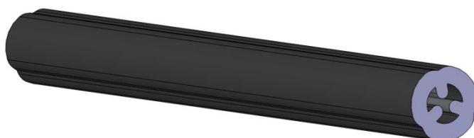
Рис.1. Заряд твердого топлива со звездообразным 3-лучевым центральным каналом.
