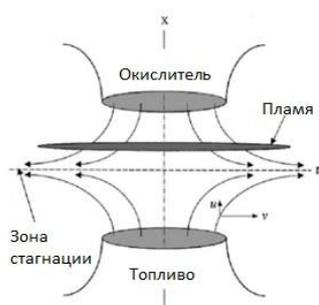
Рисунок 2. Модель противоточного диффузионного пламени
