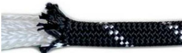
*Рисунок 7 – 48 прядная статическая веревка*
