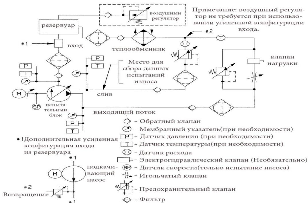
Рисунок 1- Схема стенда для тестирования электрогидравлического насоса
