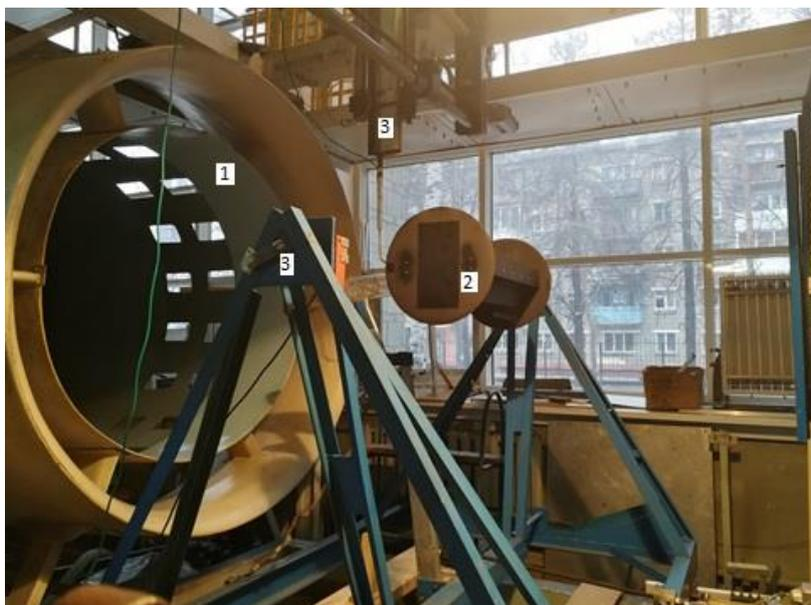
Рис. 1.Аэродинамическая труба «Т-503» с моделью моста на аэродинамических весах: 1 – Аэродинамическая труба «Т-503»; 2 –модель моста; 3 – аэродинамические веса.
