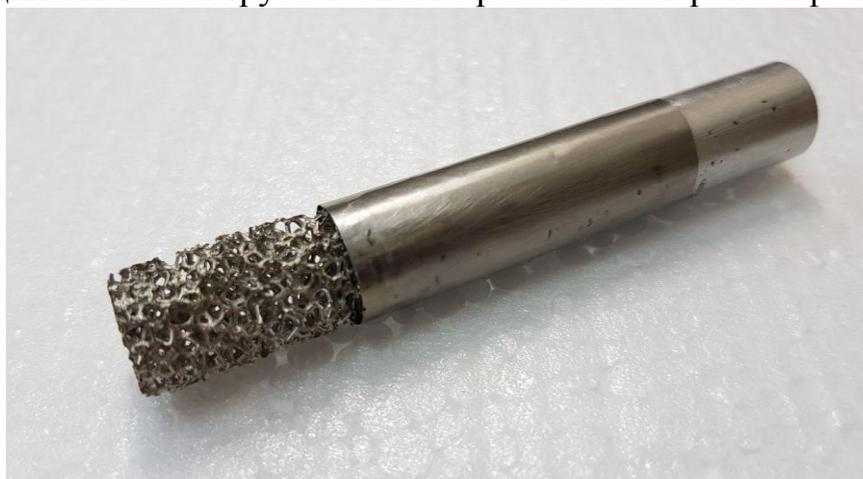
Рис. 2. Модель: Цилиндр с передней газопроницаемой вставкой из вспененного никеля с порами ячейками различного диаметра.
