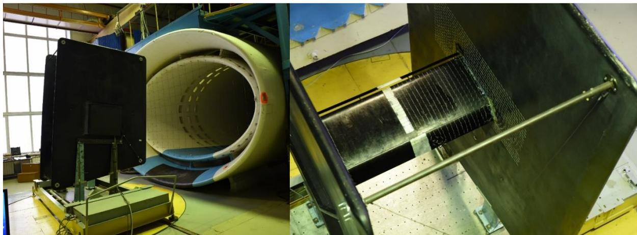
Рис. 1. Экспериментальная установка – модель отсека на ВП-203 в рабочей части аэродинамической трубы
