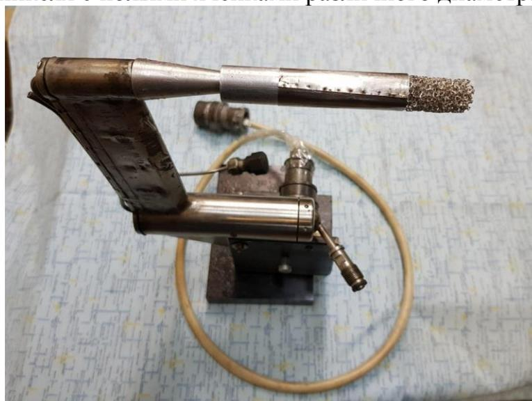
Рис. 3. Аэродинамические весы тензометрического типа
