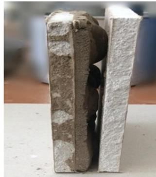
Рис. 3. Опытная шумопоглощающая панель на основе золокерамзита
