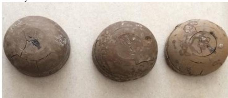
Рис. 2. Образцы золокерамзита после вспучивания
