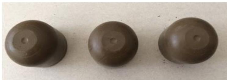
Рис. 1. Образцы золокерамзита до вспучивания
