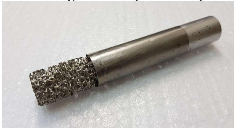
Рис. 2. Модель: Цилиндр с передней газопроницаемой вставкой из вспененного никеля с полыми ячейками различного диаметра.
