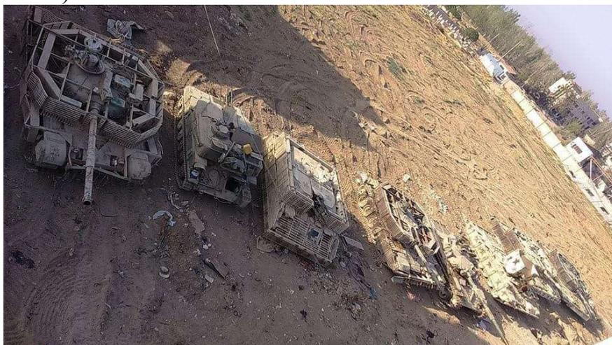
Рис 1. Объекты бронетанкового вооружения с навесной защитой
