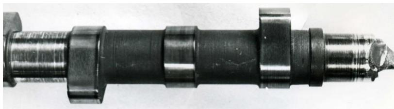
Рисунок 2 – Поломка распределительного вала механизма газораспределения двигателя внутреннего сгорания
