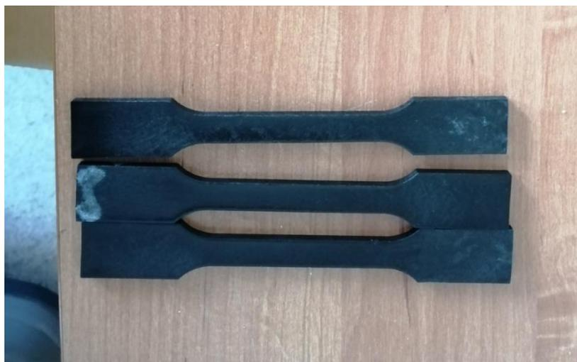
Рис.1 Образцы для физико-механических испытаний на растяжение
