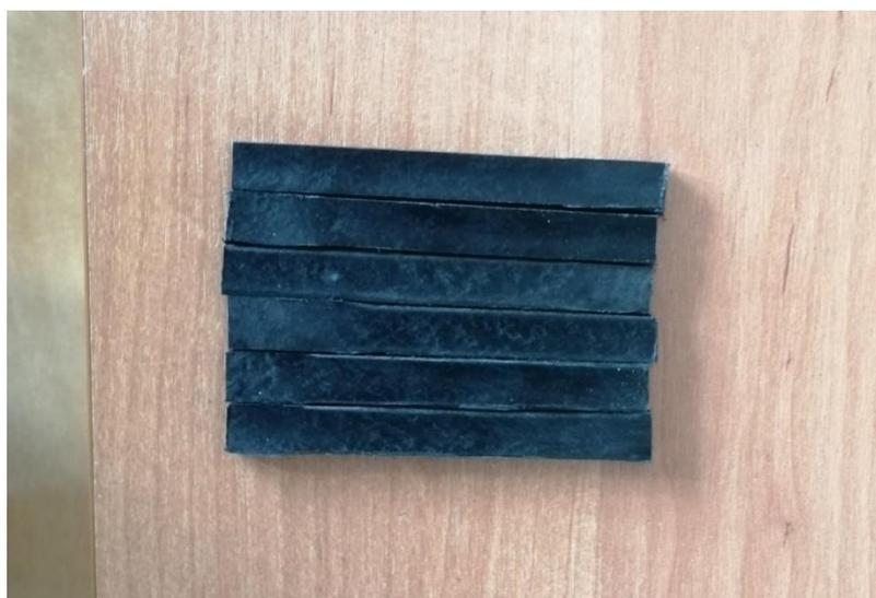
Рис.2 Образцы для физико-механических испытаний на изгиб и ударную вязкость
