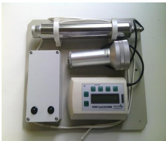
Рис. 1. Дозиметр-радиометр МКС/СРП-08А с блоками детектирования
