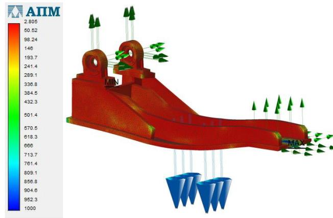
Рисунок 4 – Коэффициент запаса по прочности для нижнего структурного элемента
