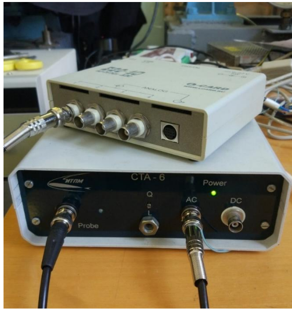
Рис. 2. Термоанемометр постоянного сопротивления СТА-6, разработанный и изготовленный в Институте Теоретической и Прикладной Механики.
