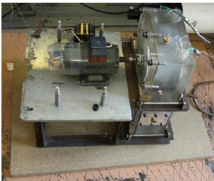
Рис. 5. Установка с полукольцевым зазором для исследования течения Куэтта
