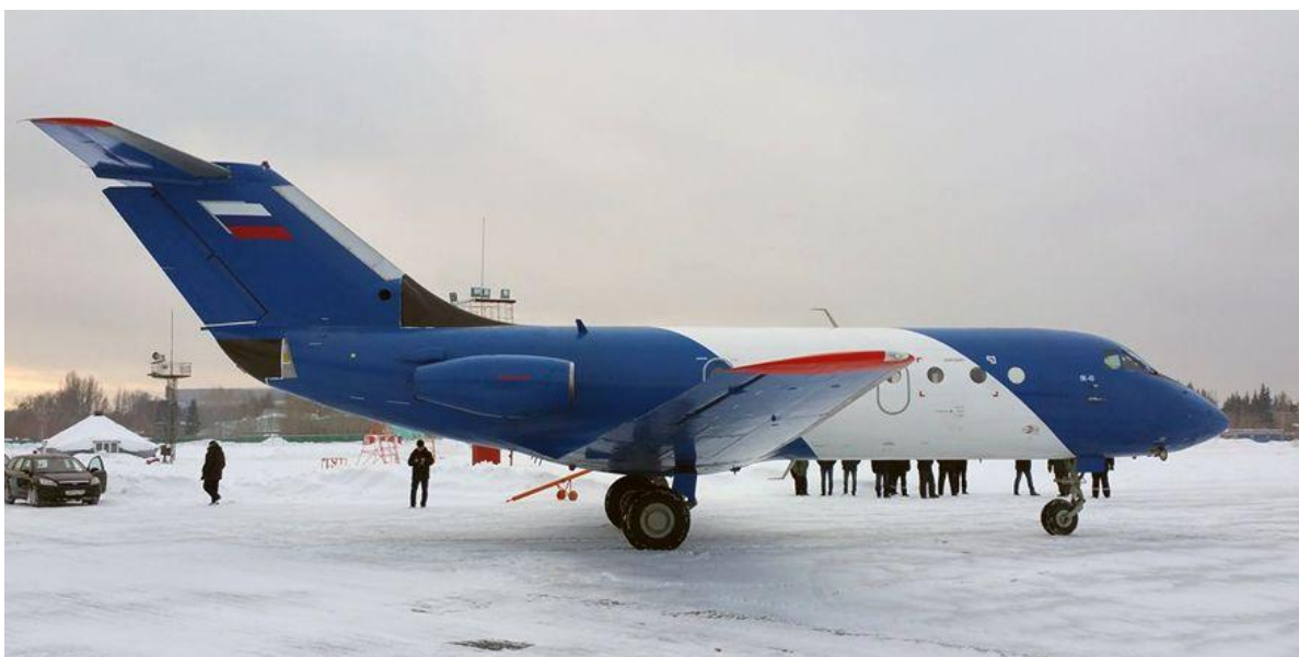
Рис. 1. Пример ремоторизованного Як-40
