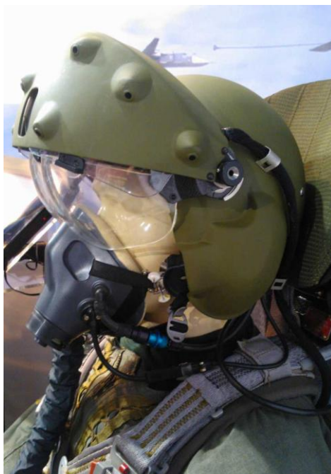
Рис. 4. «ЗШ-10 с системой целеуказания и индикации»
