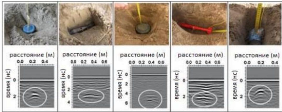
Рис. 2. Применения георадара при обнаружении мин
