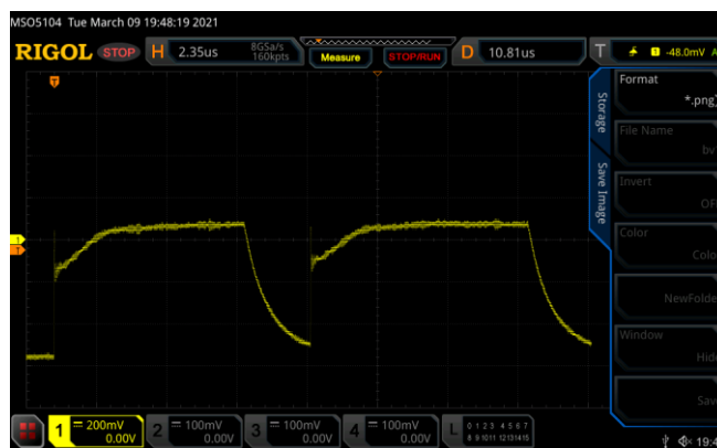
Рисунок 2 – Осциллограмма изменения потенциала электрода при коммутации поляризующего тока
