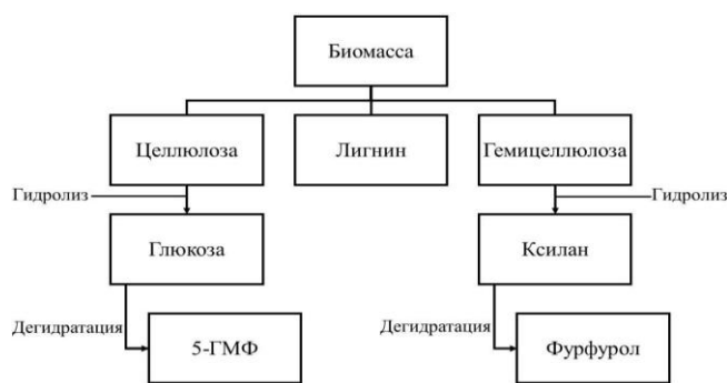
Рис. 2 – Концепция гидролиза-дегидратации лигноцеллюлозной биомассы в фурановые производные (5-ГМФ и фурфурол)
