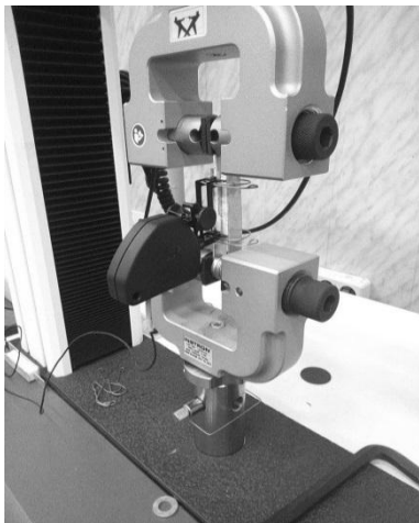
Рис. 3. Фотографии установки образцов на испытательной машине
