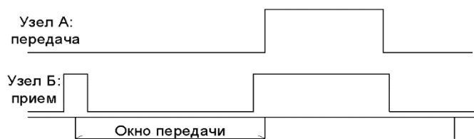
Рис. 2 узел Б прослушивает начало "пустого" окна передачи, а в следующем окне принимает пакет от узла А.
