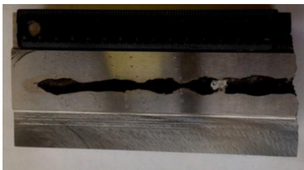
Рис. 4. Упруго-пластические волны в непробитой преграде
