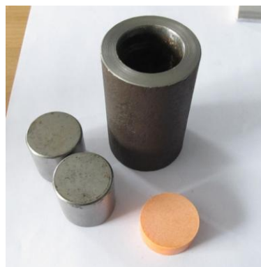
Рисунок 2 – Сборка для испытаний ВВ: 1 - муфта; 2 – ролики; 3 – шашка ВВ
