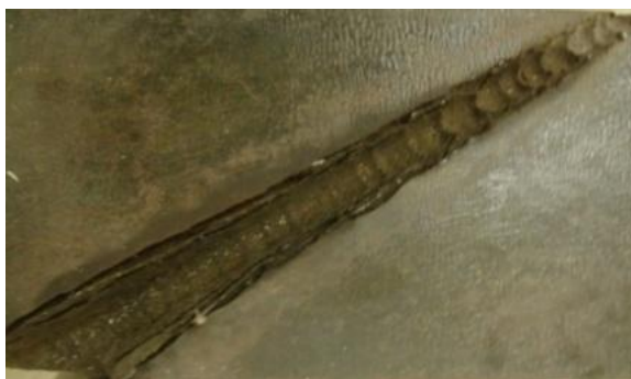
Рис. 3. Упруго-пластические волны на поверхности преграды
