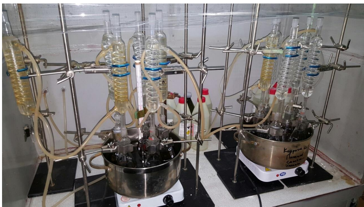
Рисунок 2 – Вариант компоновки ёмкостей для испытаний 5 комплектов образцов.
