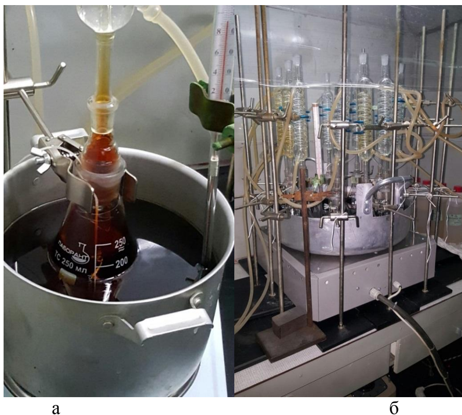
Рисунок 1 – Компонка емкостей для коррозионных испытаний: а – для одного комплекта образцов, б – для 11 комплектов образцов.
